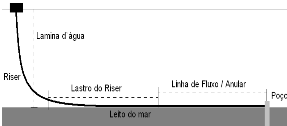
Ilustração 1 - Esquema de um Riser conectado a uma linha de fluxo ou anular
